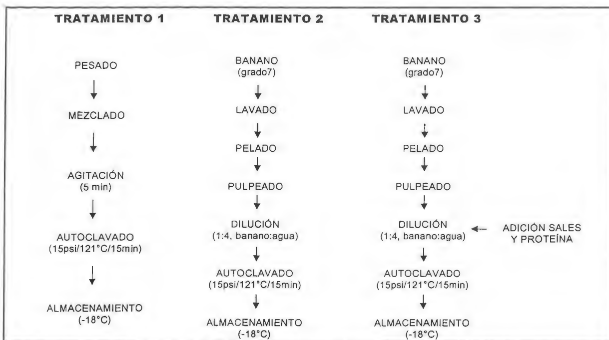
FIGURA 5. Diagrama de flujo del proceso de preparación de los tratamientos para el proceso de fermentación.
