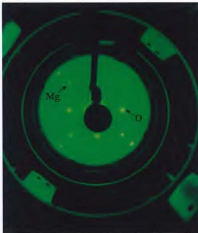
Figura 2.3: Fotografía de un patrón de LEED de una muestra cristalina fcc (cúbico centrado en la cara) de óxido de magnesio MgO en su plano (100). Las flechas en la imagen indican la posición de los iones de Mg^{2+} y O^{2-} . Los iones O^{2-} se localizan en la sección fcc del octaedro de la red y los iones Mg^{2+} se encuentran ubicados en los huecos del octaedro.
