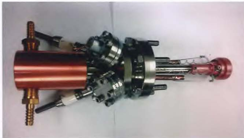
Figura 5.3: Fotografía de la fuente de átomos. Se observan las distintas secciones presentadas en la Figura 5.2. El filamento de tungsteno, en contacto con el crisol de molibdeno permite alcanzar temperaturas estables de 500°C.
