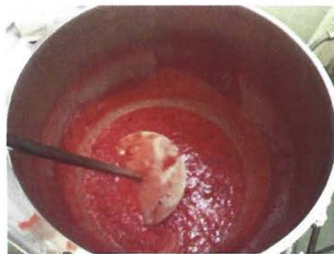
Figura 3. Pasteurización de la fresa para el proceso de producción de vino a base de fresa, INA 2016
