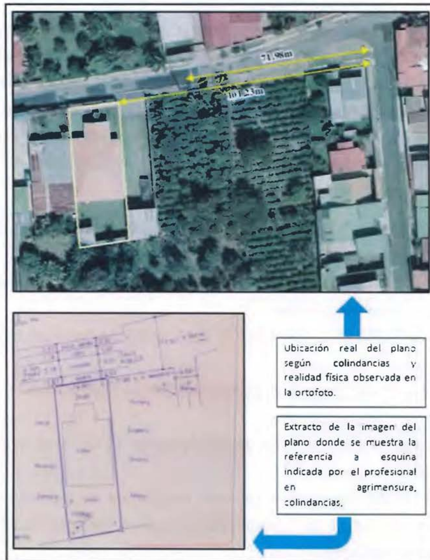
Figura 38. Ejemplo de plano que presenta discrepancias entre la ubicación por referencia a esquina indicada en el plano y la ubicación respecto al mejor ajuste. Elaboración propia.
