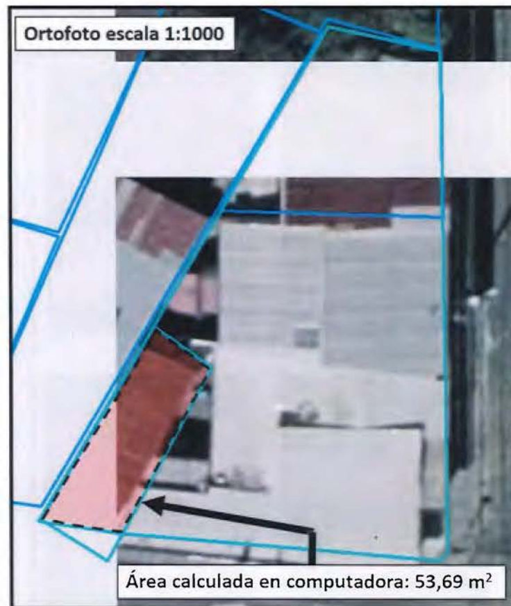
Figura 101. Detalle del traslape total de planos. Tomado de la base de datos del Mapa Catastral
