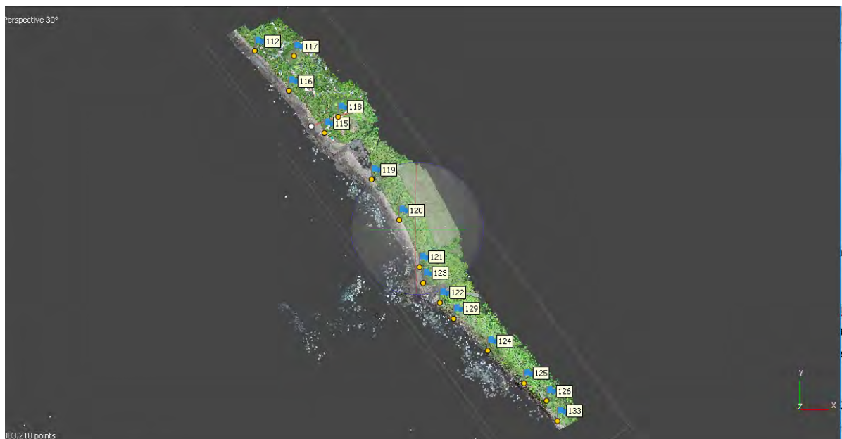
Figura 7: Ubicación de los puntos de control terrestres mediante marcadores.
