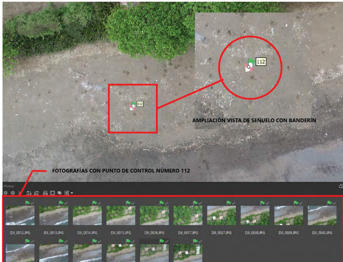
Figura 8: Vista del punto de control 112. Ubicación precisa del banderín para indicar el punto de control.
