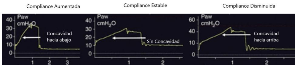
Ilustración 10 Curvas de presión - tiempo según el estado de compliance pulmonar. Imagen modificada de Arnal, J. (2018). Monitoring Mechanical Ventilation using Ventilator Waveforms, 1st Edition.
