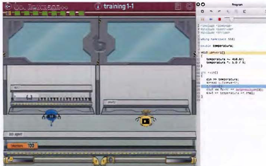
Figura 6.19. Problema de conversión de temperaturas resuelto con dos hilos de ejecución
