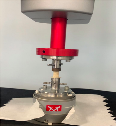
Figura 21. Prueba mecánica a bioandamiaje
