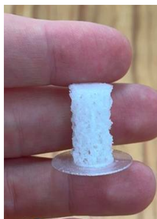
Figura 14. Estructuras impresas en PLA
