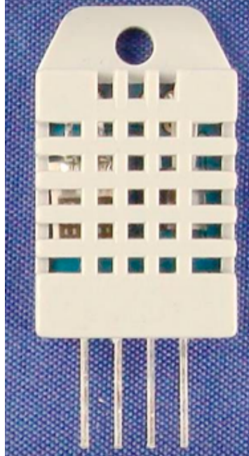
Figura 3.16: Sensor de temperatura y humedad relativa (Aosong Electronics Co, Ltd, Desconocido)
