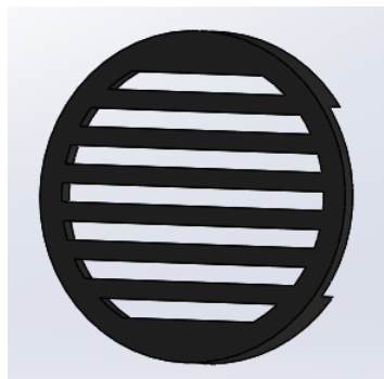
Figura 3.28: Rejilla de la válvula de exhalación. (Elaboración propia, 2021)
