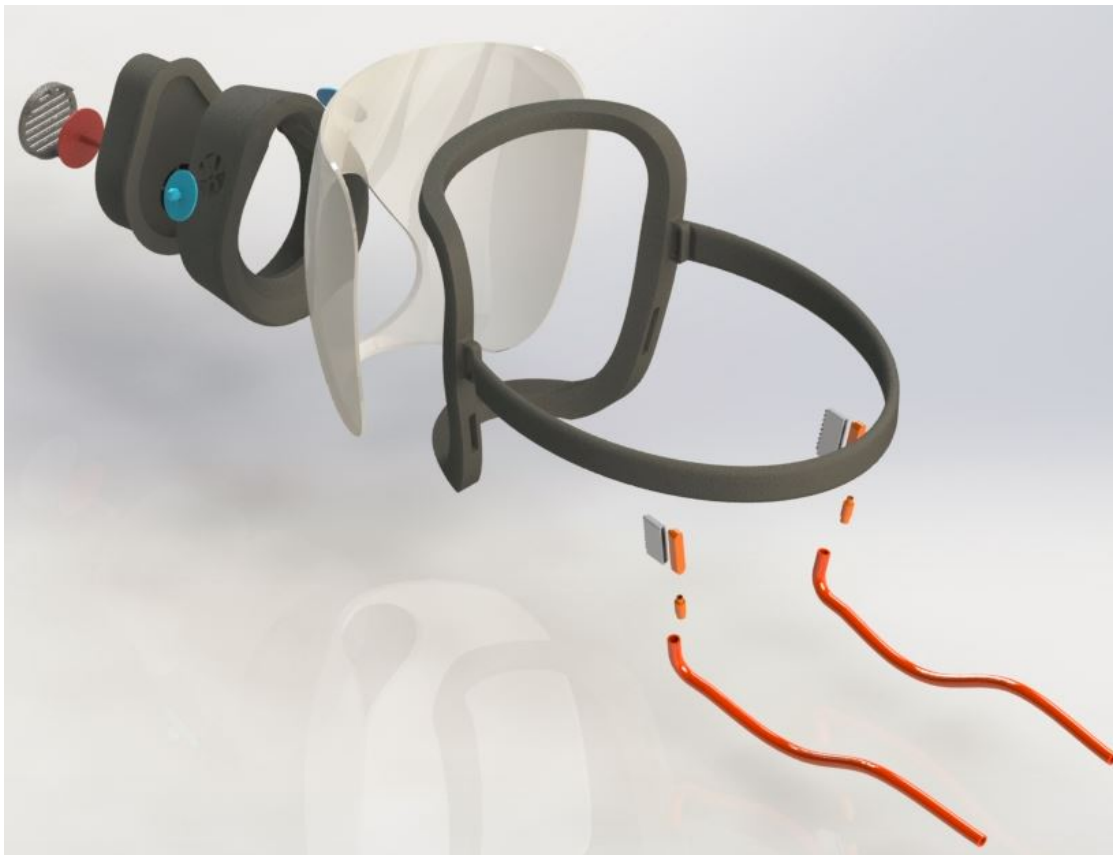
Figura 3.34: Diseño de propuesta del protector facial explosionado. (Elaboración propia, 2021)
