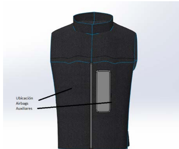
Figura 4.7: Diagrama de ubicación de los airbags frontales en modelo 3d del chaleco airbag . Fuente: Elaboración Propia
