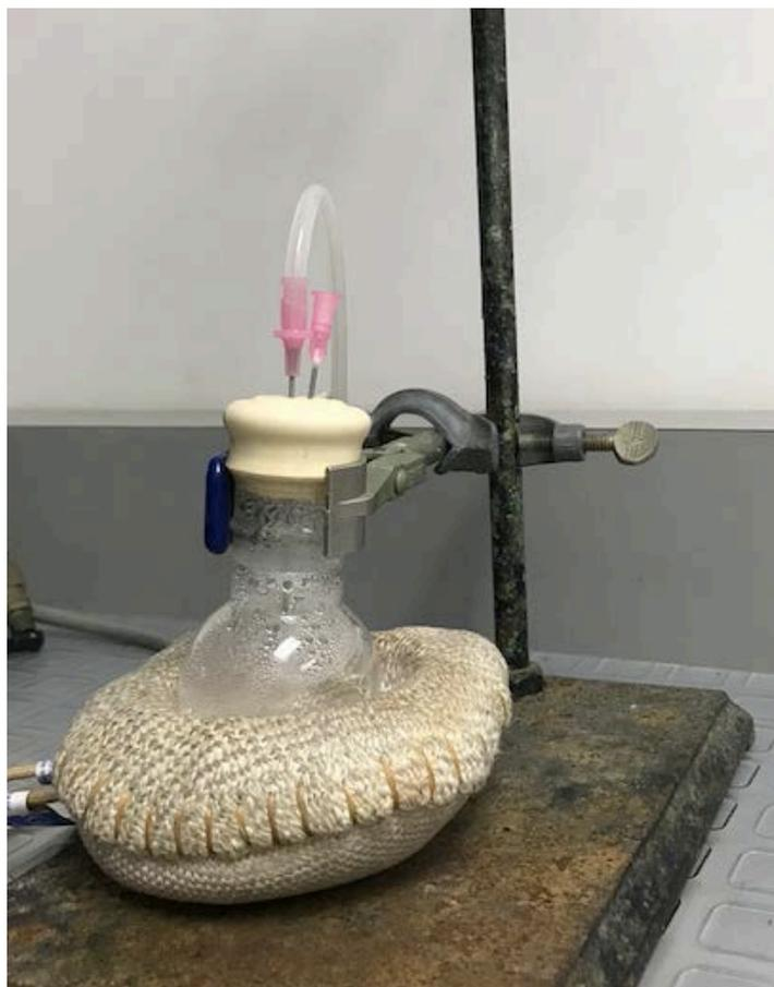
**Figura 3.2.** Sistema de humidificación del CO<sub>2</sub>
