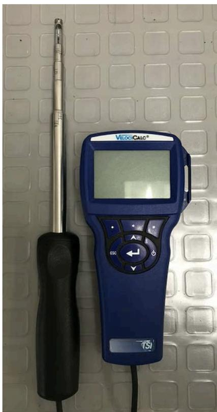
**Figura 3.3.** Anemómetro para la medición de humedad.
