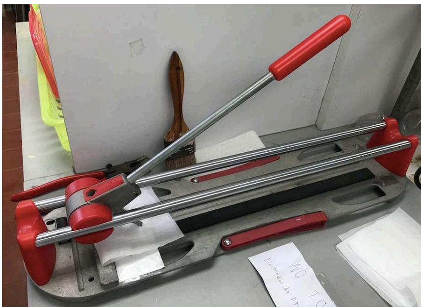
**Figura 3.7.** Máquina cortadora de vidrio.
