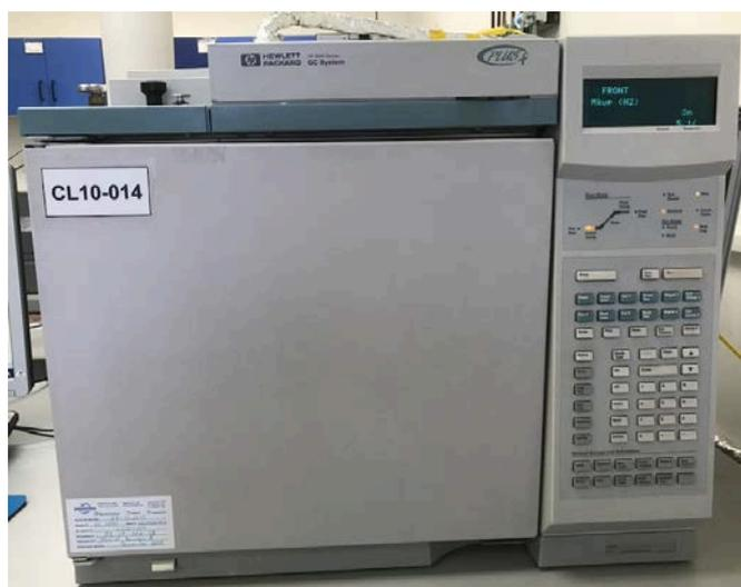
**Figura 3.10.** Cromatógrafo de gases *HP*.
