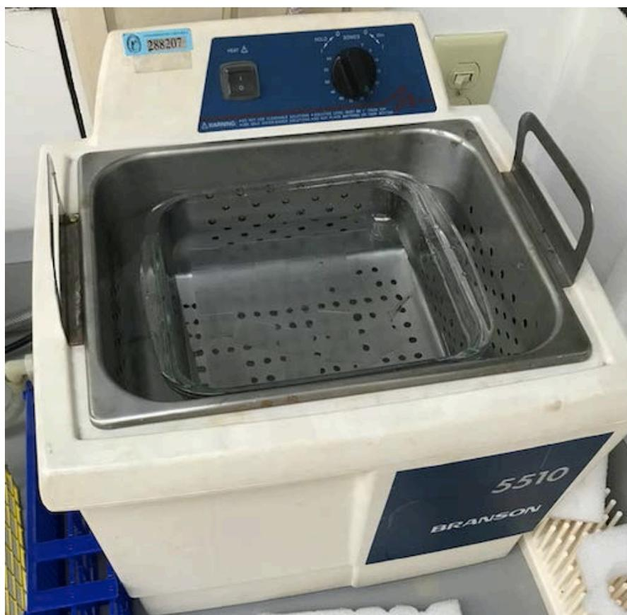
**Figura 3.9.** Equipo de baño ultrasonico Branson 5510
