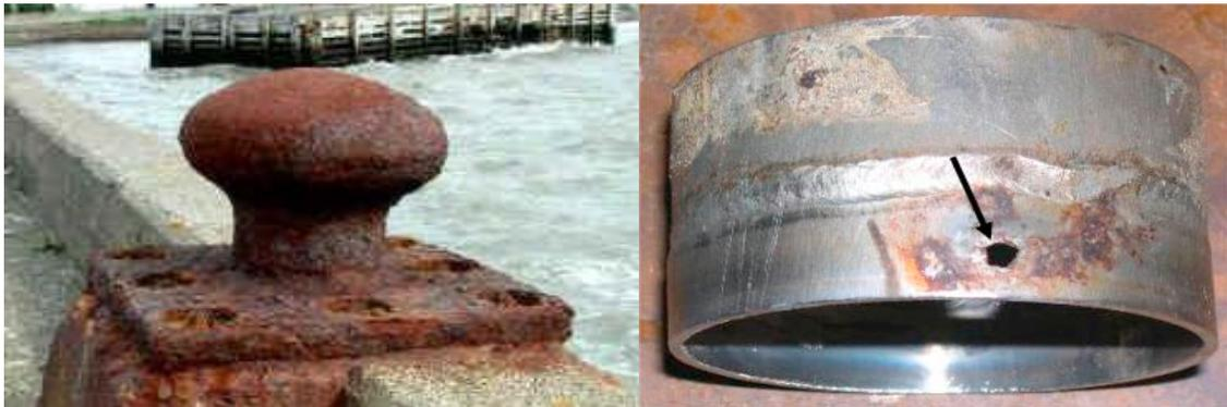
**Figura 3.** Diferencia entre corrosión uniforme (izquierda) y corrosión localizada (derecha). Tomado de AMPP [15] y Tait [16].
