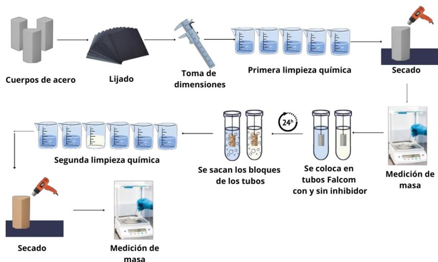
**Figura 11.** Representación gráfica del ensayo gravimétrico.
