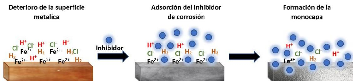
**Figura 8.** Formación de la monocapa protectora sobre la superficie del acero. Tomado y adaptado de Ma *et al.* [29].
