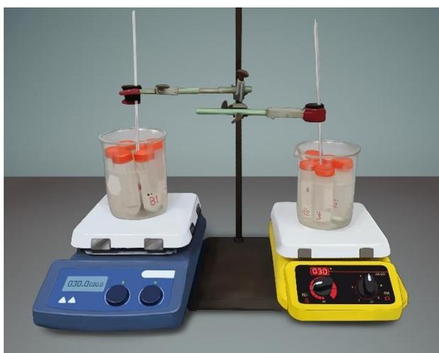
**Figura 13.** Sistema montado para el experimento de ensayo gravimétrico variando temperaturas.
