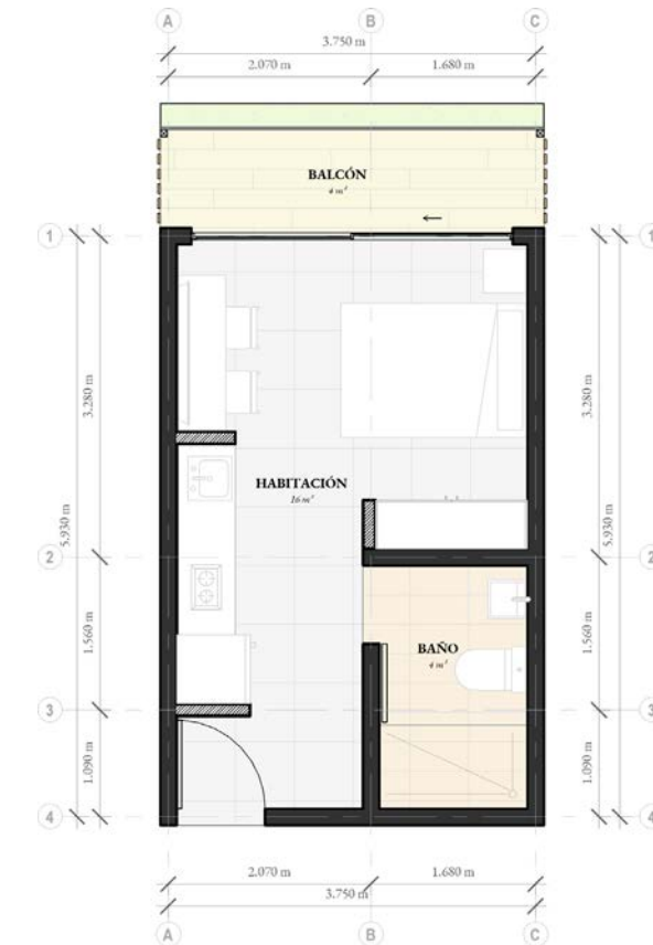
Imagen 7.42 Planta de distribución arquitectónica ampliada tipología de cuartería de un dormitorio. Fuente: Cambroner, V., Rodríguez, N. (2023)
