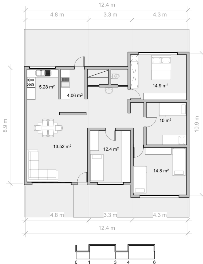
Planta 3.4. Planta arquitectónica de la tipología T4DF, 4 Dormitorios Ampliables. Fuente: Soto Cedeño, M. (2022)
