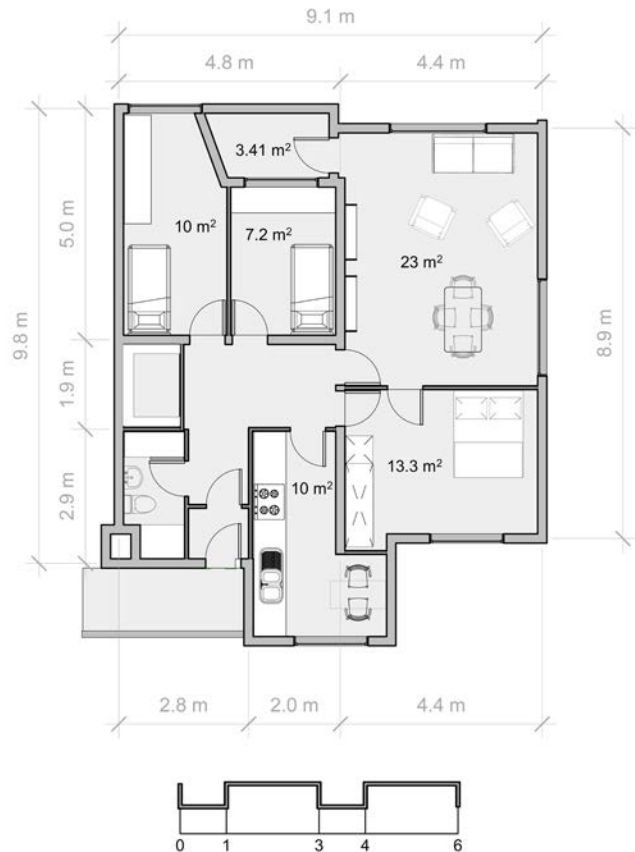
Planta 3.8. Planta arquitectónica del apartamento de 3 dormitorios, Edificio NORD 10. Fuente: Soto Cedeño, M. (2022)
