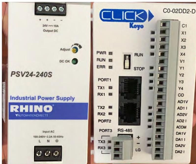
Figura 56: Controlador lógico programable y fuente de poder de 24 VDC, tomada en Bello Horizonte, Escazú, San José, Costa Rica. (elab. propia)
