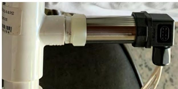
Figura 59: Sensor de presión con señal de salida de 4-20 mA, tomada en San Rafael, Escazú, San José, Costa Rica. (elab. propia)
