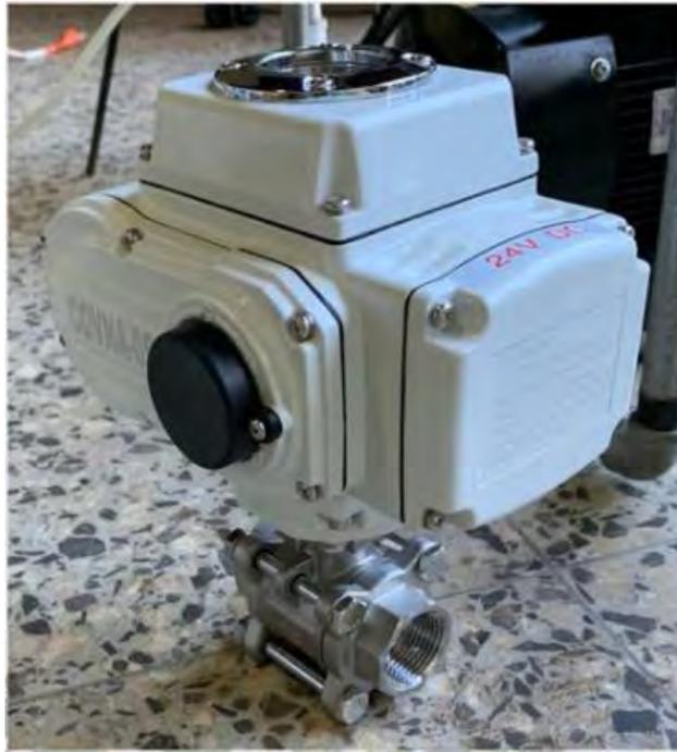
Figura 57: Válvula reguladora para la descarga de agua, tomada en San Rafael, Escazú, San José, Costa Rica. (elab. propia)
