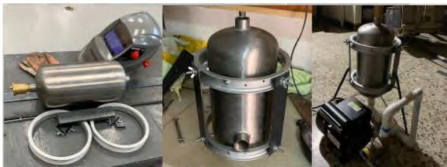
Figura 43: Proceso de construcción de soporte del tanque de mezcla del prototipo 1 (elab. propia)
