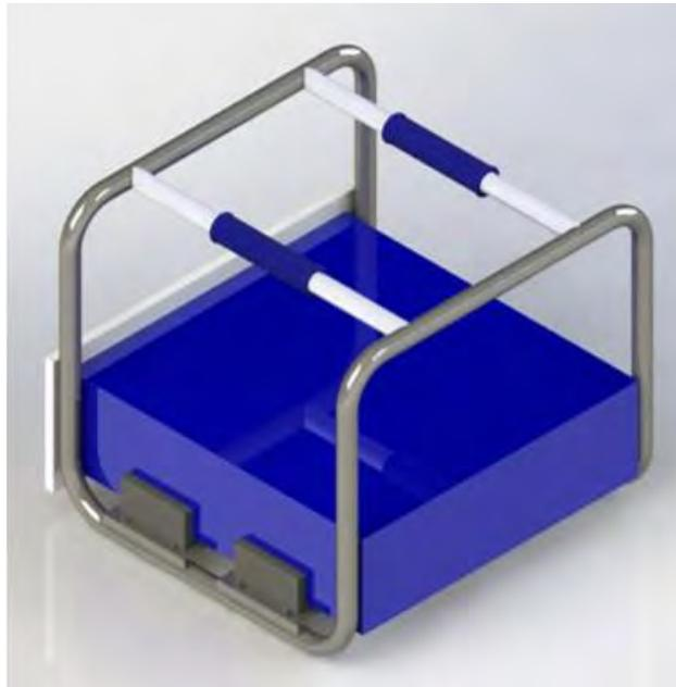
Figura 40: Marco para el generador de ozono del prototipo 1 (elab. propia)
