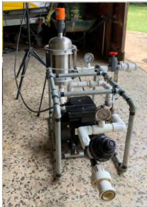
Figura 42: Marco para la bomba generadora de MNB del prototipo 1 (elab. propia)
