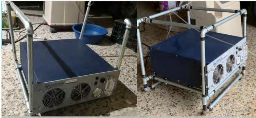
Figura 41: Proceso de construcción del marco para el generador de ozono del prototipo 1 (elab. propia)
