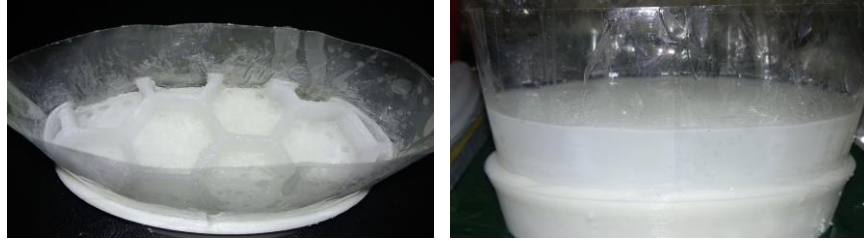
Figura 3.57. Molde de silicona rodeado de cinta para embalaje y cubierto de vaselina: sin el caucho de silicona chorreado (izquierda) y, con el fluido vertido (derecha).
