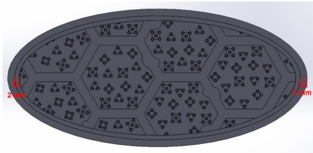
Figura 3.47. Espesor de las paredes internas y externas del molde biotextural. Elaboración propia con el programa SolidWorks, 2022.
