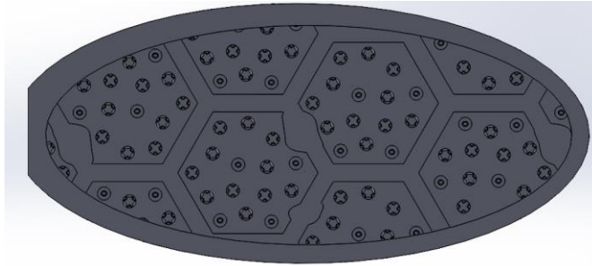
Figura 3.46. Molde biotextural en negativo con las dimensiones del prototipo. Elaboración propia con el programa SolidWorks, 2022.
