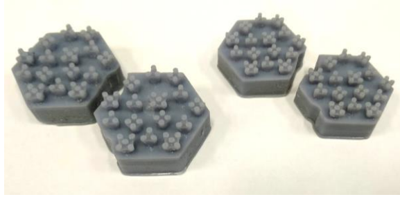
Figura 3.19. Tercera impresión 3D en resina a diferentes escalas de las celdas bioinspiradas con ventosas de los filamentos acentuadas ensamblado tomando en cuenta los canales y las mesetas. Escalas al 200% y 150% (De izquierda a derecha). Elaboración propia con la impresora 3D Phrozen Mini 4K, 2022.
