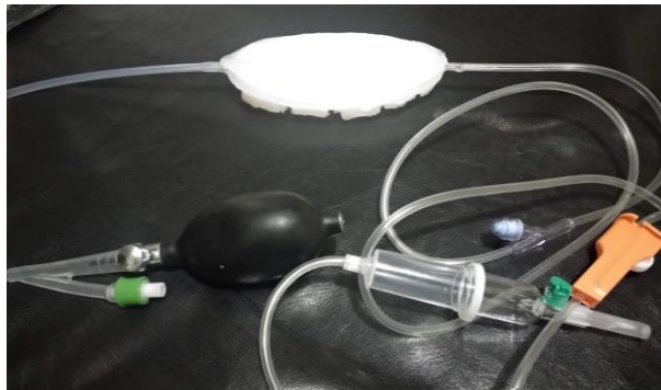
Figura 3.62. Prototipo de robótica suave con superficie texturada bioinspirada en la Lithobates vibicarius finalizado.
