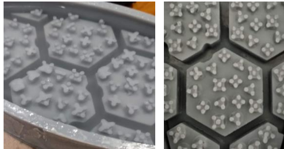
Figura 3.52. Acercamiento al molde biotextural impreso: lleno de alcohol isopropílico para posteriormente remover el material residual (izquierda) y después de remover el material residual (derecha). Elaboración propia con la impresora de resina Phrozen Sonic Mini 4K, 2022.
