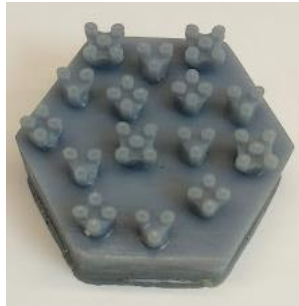
Figura 3.20. Celda bioinspirada con ventosas de los filamentos acentuadas a escala del 200% . Elaboración propia con la impresora 3D Phrozen Mini 4K, 2022.
