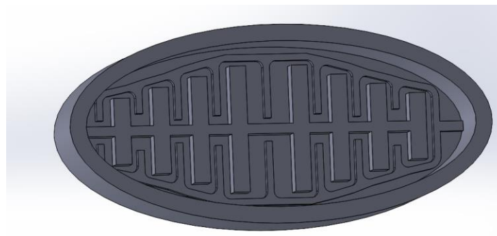
Figura 3.44. Diseño final del molde con canales para el sistema neumático y para el sistema de humectación. Elaboración propia con el programa SolidWorks, 2022.
