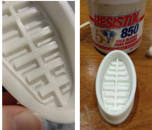
Figura 3.49. Molde con canales para sistema neumático y de humectación impreso: con imperfectos (izquierda) y con sus agujeros rellenos de goma (derecha). Elaboración propia con la impresora de filamento Anycubic Chiron, 2022.
