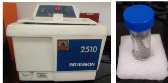
Figura 3.33. Máquina de limpieza por ultrasonido marca Branson modelo 2510 (Izquierda) y placa de acero 304 dentro de tubo falcón (derecha).
