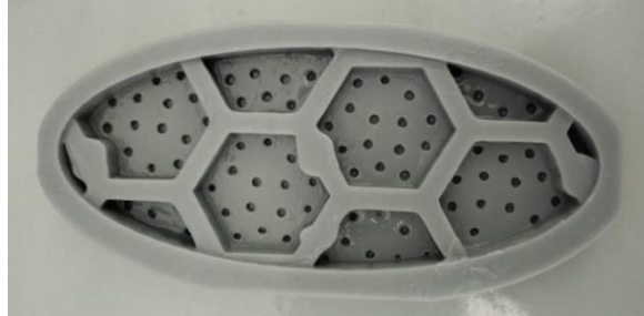
Figura 3.51. Molde biotextural en negativo impreso. Elaboración propia con la impresora de resina Phrozen Sonic Mini 4K, 2022.
