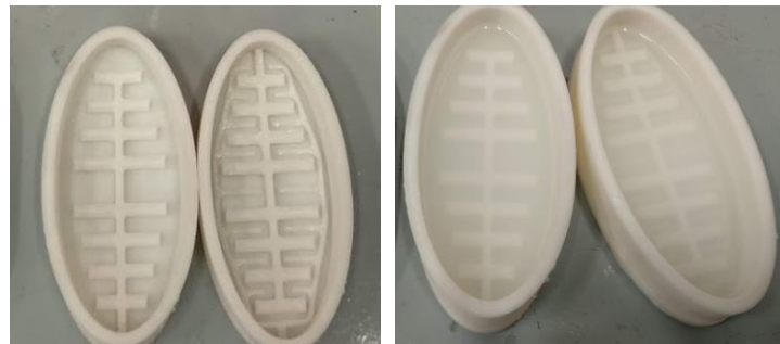
Figura 3.50. Moldes con canales impresos: vacíos (izquierda) y con la silicona de platino (derecha). Elaboración propia con la impresora de filamento Anycubic Chiron, 2022.
