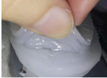
Figura 3.61. Revisión visual del sellado de los conductos de aire durante el ensamble del prototipo.
