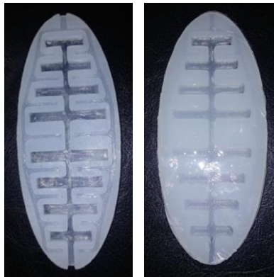
Figura 3.59. Capa con los canales para el sistema neumático y para el sistema de humectación: vista superior a los canales (izquierda) y, vista inferior (derecha).
