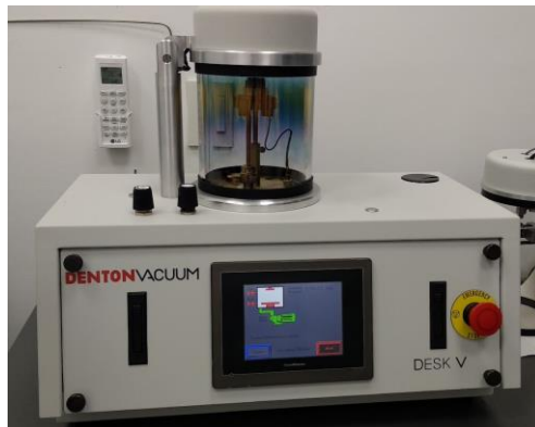
Figura 3.21. Cobertor Iónico (Denton Vacuum Desk V) utilizado para la preparación de la celda bioinspirada para su visualización en el microscopio electrónico de barrido.
