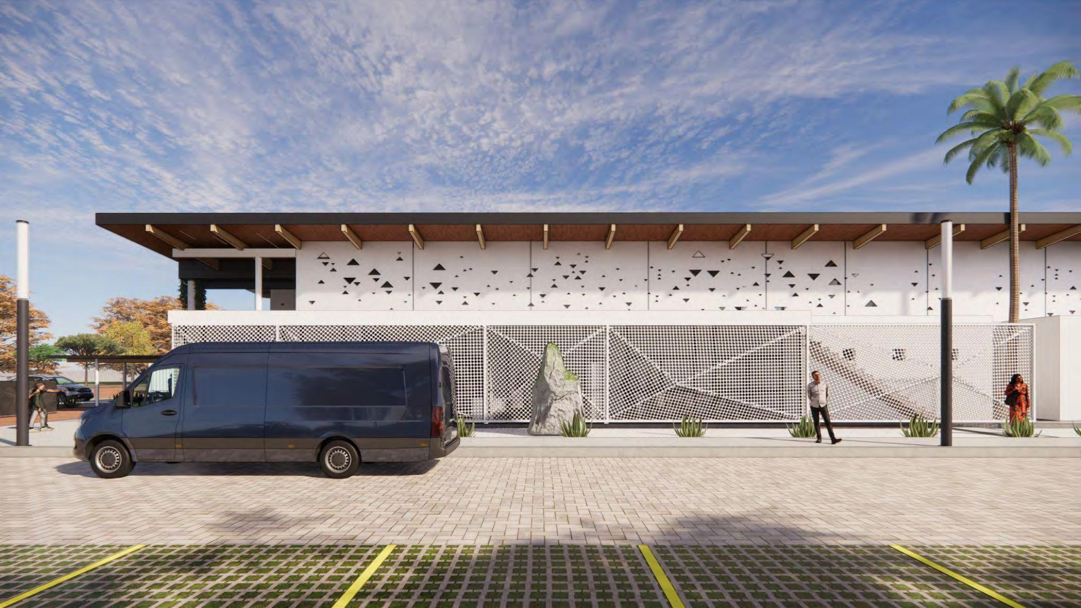
Salimos del proyecto y tenemos la fachada este, que es la elevación en la cual se trabaja con materiales perforados para permitir el paso de iluminación natural controlado.
