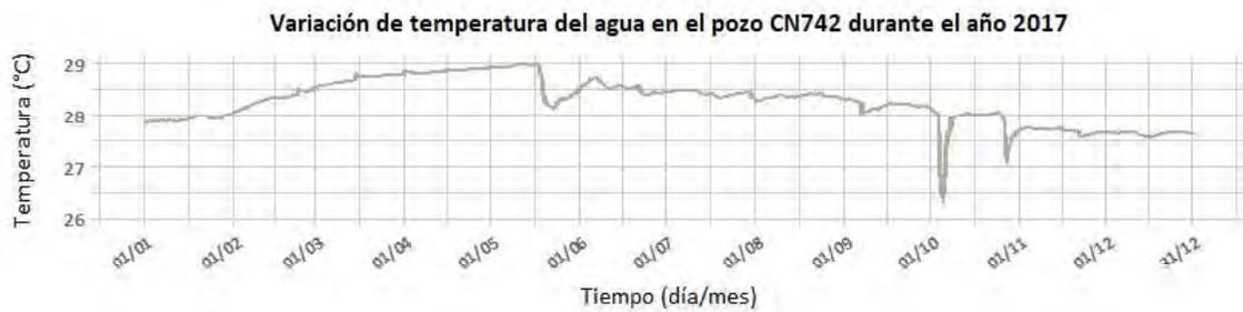
Figura 101 Variación de la temperatura en los pozos CN-735, CN-741 y CN-742 durante el año 2017
