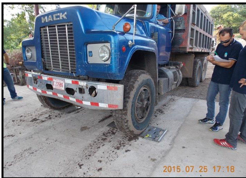
Figura 4-36. Pesaje de los camiones.
