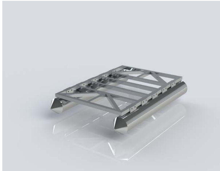
Figura 3.4: Elementos flotadores [Elaboración propia]
