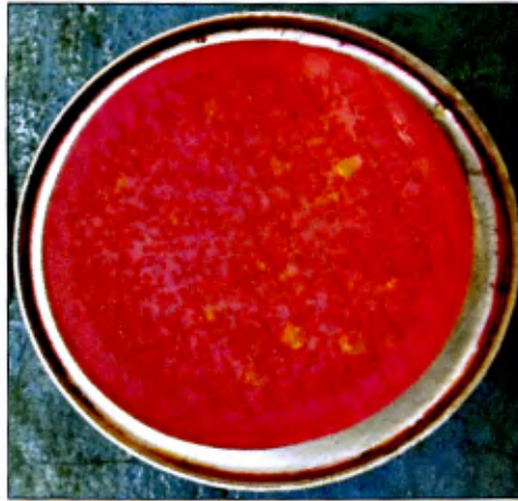
Figura IV.66. Prueba de coliformes, acueducto de Tres Amigos
