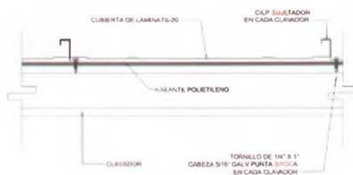
DETALLE DE TS-20 SENCILLA CON AISLAMIENTO
