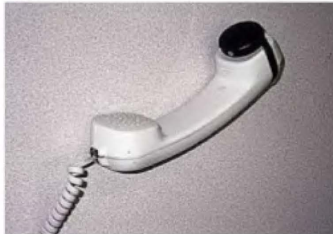
Figura 86: Amplificadores de la señal acústica
