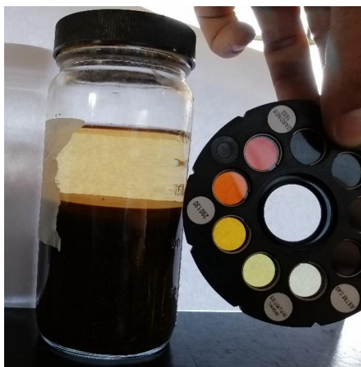
Figura 12: Prueba de impurezas orgánicas para arena de Guápiles.
