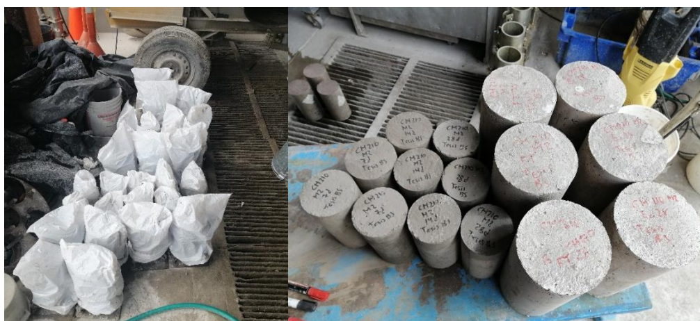
Figura 14: Especímenes cilíndricos de concreto
