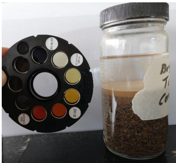
Figura 11: Prueba de impurezas orgánicas para arena de Cerro Minas.
