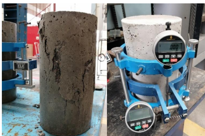
Figura 17: Montaje y falla para el ensayo de módulo de elasticidad para espécimen de concreto de 210 \text{ kg/cm}^2 ( 20,6 \text{ MPa} )
