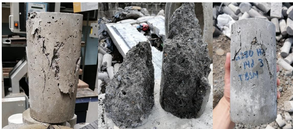
Figura 16: Fallas a compresión simple de especímenes de concreto con un rango de resistencia entre 210 \text{ kg/cm}^2 ( 20,6 \text{ MPa} ) y 280 \text{ kg/cm}^2 ( 27,5 \text{ MPa} )
