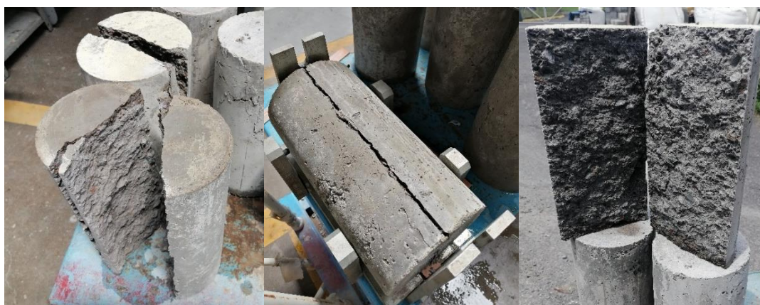
Figura 18: Montaje y falla para el ensayo de resistencia a la tracción de especímenes de concreto con un rango de resistencia entre 210 \text{ kg/cm}^2 ( 20,6 \text{ MPa} ) y 420 \text{ kg/cm}^2 ( 41,2 \text{ MPa} )
