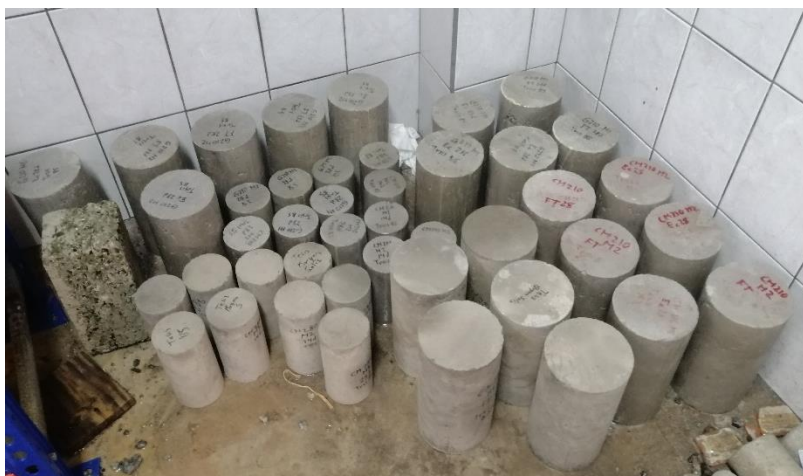
Figura 15: Almacenamiento de especímenes en la cámara húmeda
